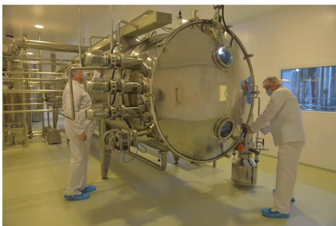
Próżniowa suszarnia taśmowa - hala produkcyjna Greenvit w Zambrowie
